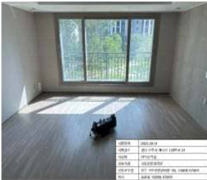
<그림 1> 표준경량충격원(Tapping machine)
