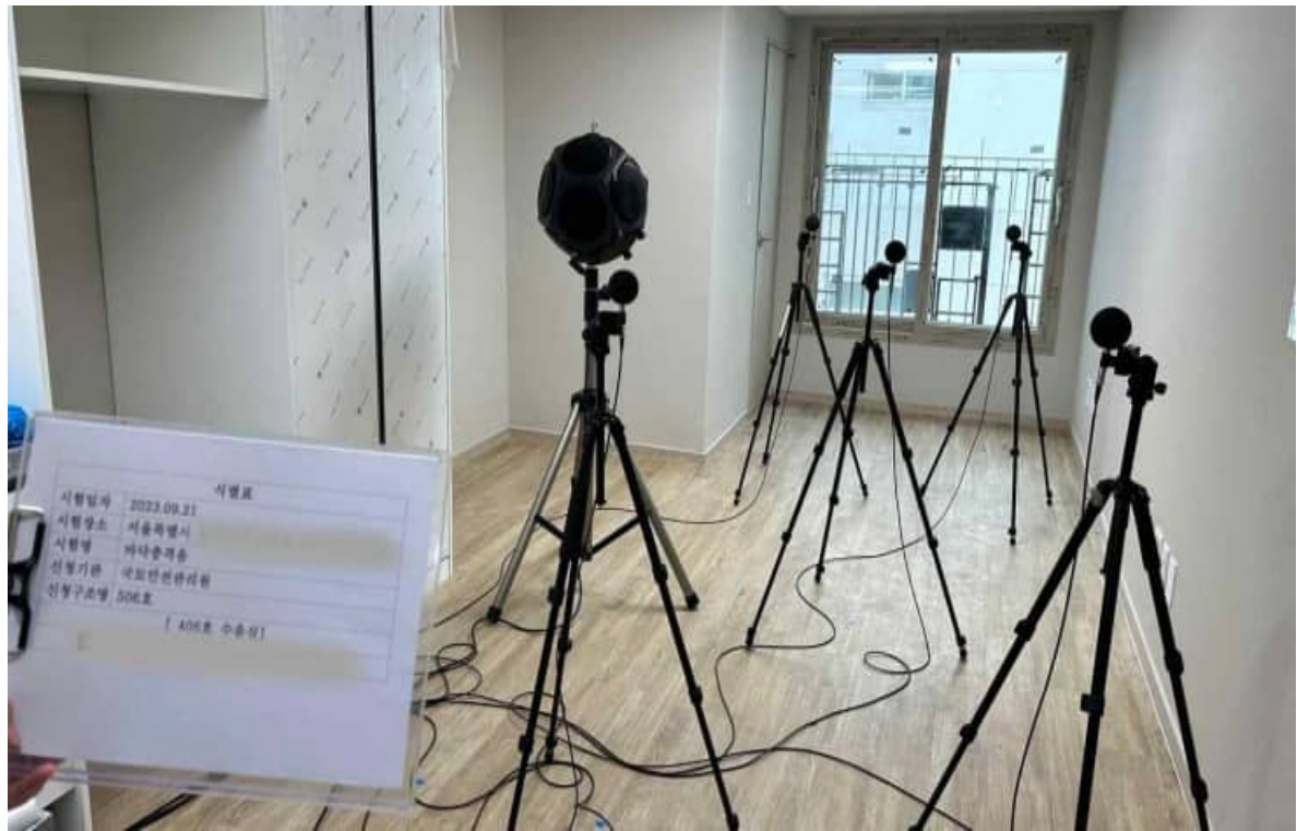
바닥충격음 성능검사 (수음실) - 음원실의 잔향시간 측정
