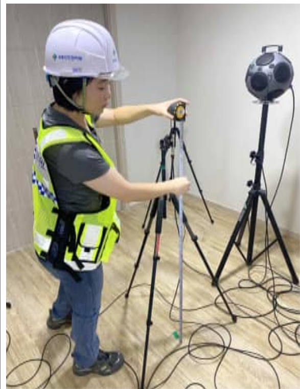
성능검사기관(국토안전관리원) 현장 관리 - 측정장비 설치 상태 확인
