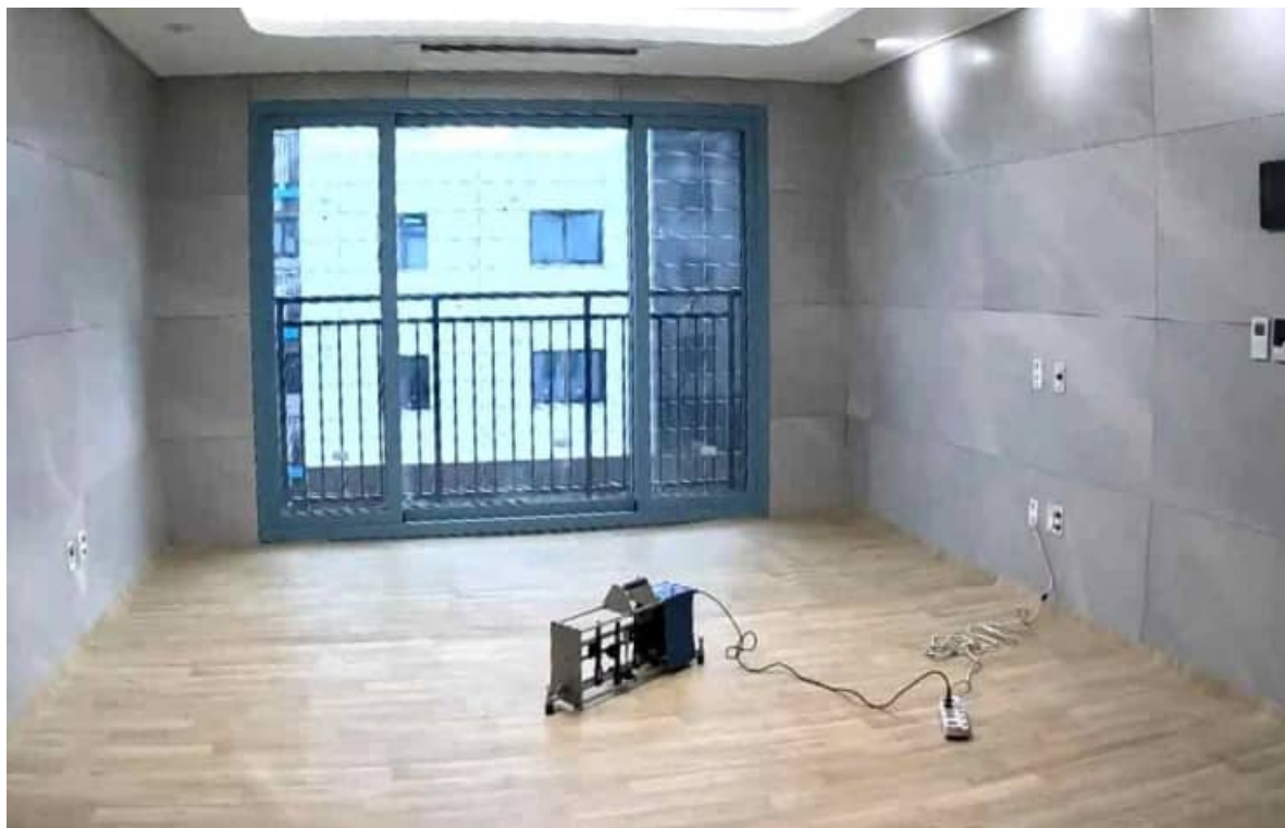
바닥충격음 성능검사 (음원실) - 경량충격음(타핑머신)
