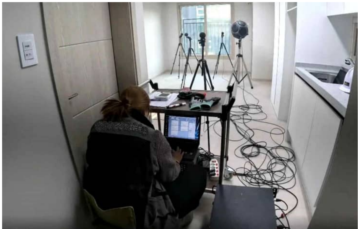
바닥충격음 성능검사 (수음실) - 마이크로폰을 이용하여 음원실에서 발생한 충격음 측정
