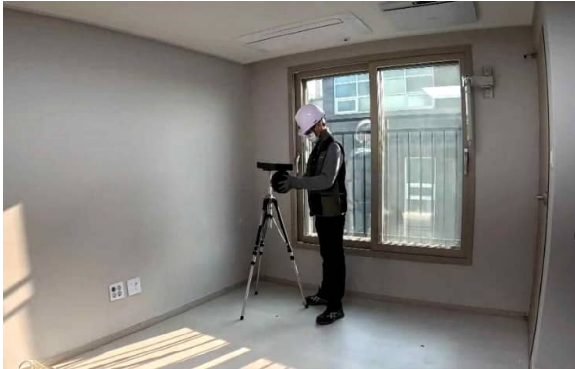
바닥충격음 성능검사 (음원실) - 측정보조 기기 / 중량충격음(고무공)
