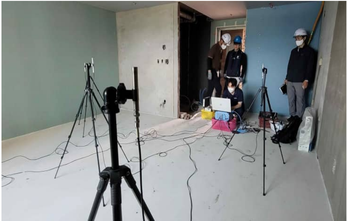
성능검사기관(국토안전관리원) 현장 입회 - 수음실 측정 절차 확인
