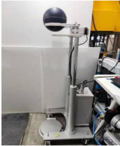
바닥에 설치된 충격력 측정기(로드셀)
